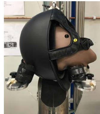
Figur 7. Det hjälmklädda huvudets initiala position vid snett islag på främre delen av hjälmen (rotation kring z) I islag 3 var vinkeln kring x-axeln 10^\circ och y-axeln 65^\circ .
