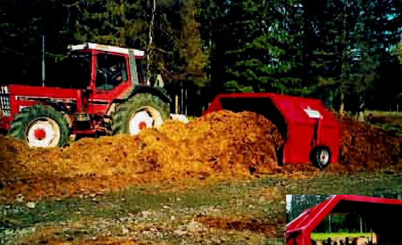
Bild 7. I JTI:s försök användes en kompostvändare som genom täta omblandningar påskyndade komposteringsprocessen. Den snabba komposteringen leder till ett högt växtnäringsvärde. Gödseln blir dessutom lätt att sprida och bruka ned i åkermark.
